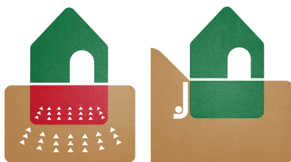
Afb. 29 & 30 - Probleem = vochtinfiltratie en capillaire vochttopstijging -> Mogelijk oplossing door het plaatsen van een waterdicht membraan + drainerend systeem
