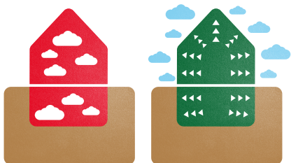
Afb. 27 & 28 - Probleem = condensatie -> Oplossing = ventilatie
