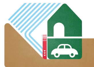
Afb. 7 - Water dat binnenstroomt door afvloeiing / Oplossing: installatie van een waterdicht systeem
